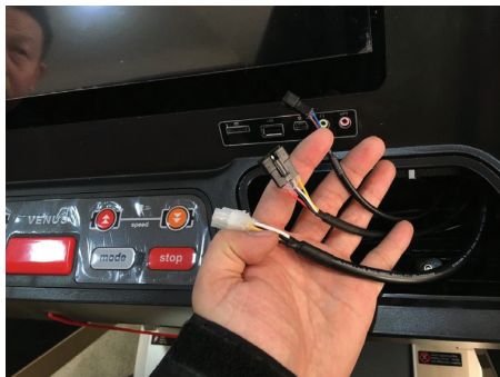
(Рис. 3) правый сигнальный кабель, кабель подсветки, кабель питания
